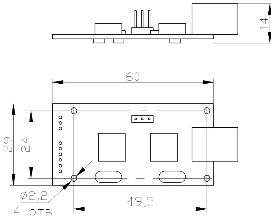
**Габаритные размеры корпуса платы обработки сигналов вместе с разъёмом D-SUB**
