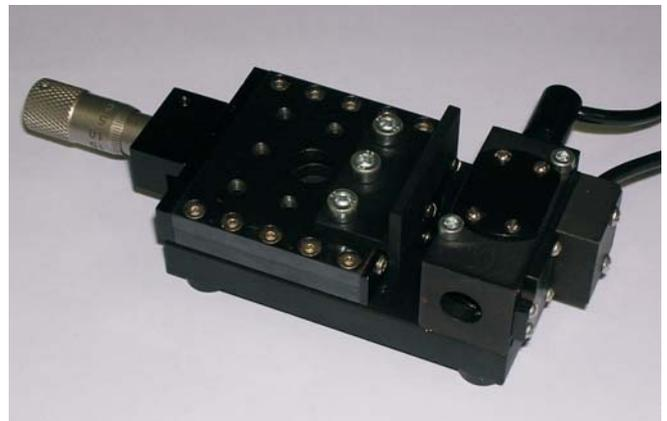
Однокоординатный позиционер, оборудованный датчиком IDS-4-LD.
